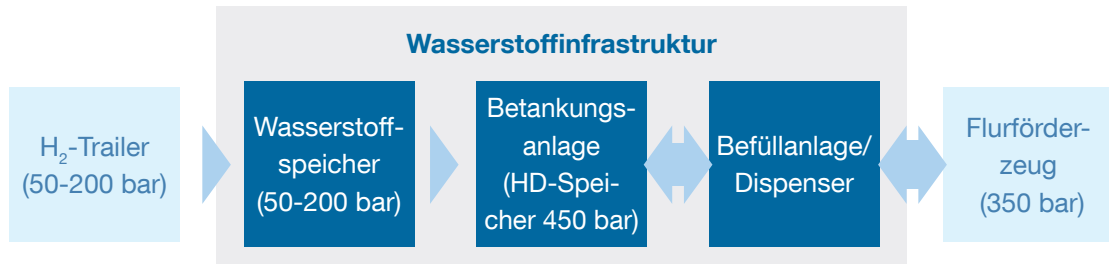
Abb. 2-2: Schematische Darstellung Wasserstoffversorgung
