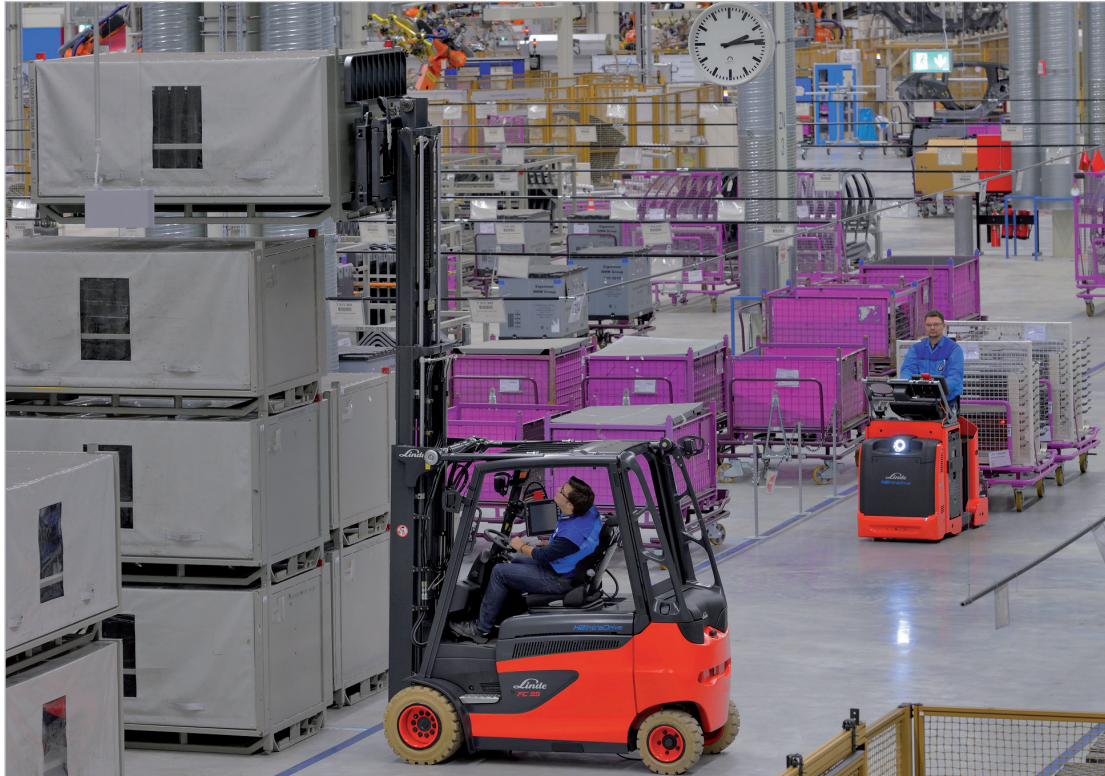
Abb. 1-2: Einsatz von wasserstoffbetriebenen Flurförderzeugen im CFK-Karosseriebau im BMW-Werk Leipzig
