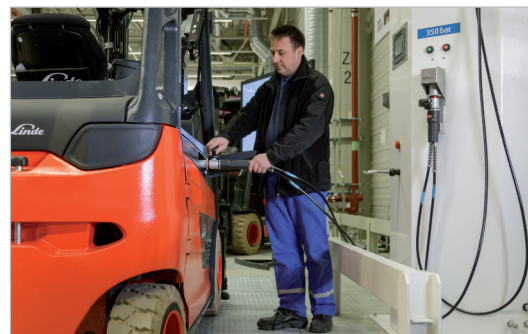
Abbildung 2-6: Betankung eines wasserstoffbetriebenen Gabelstaplers
