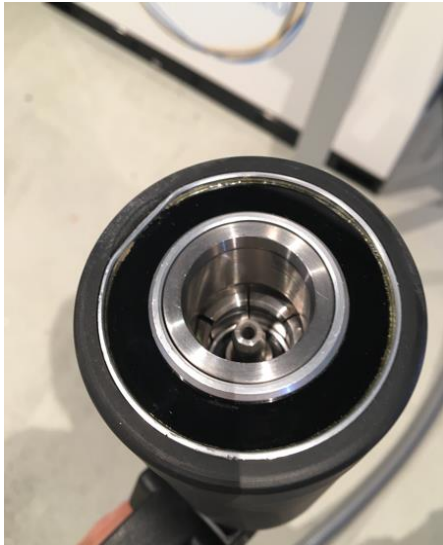
Abbildung 13: IR-Sensor an einer H 2 -Befüllkupplung
