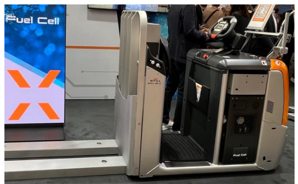
Abbildung 37: Still-Niederhubkommissionierer mit offenem Batterietrog
