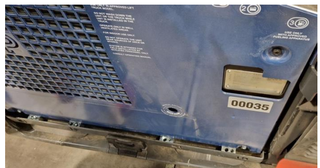
Abbildung 3: Einbausituation der Brennstoffzelle.
