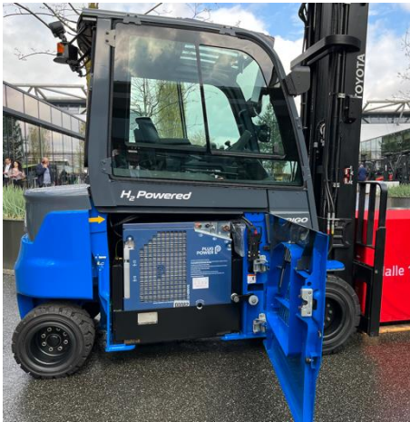
Abbildung 35: Toyota-Stapler mit geöffneter Batterietrogtür für die H 2 -Betankung
