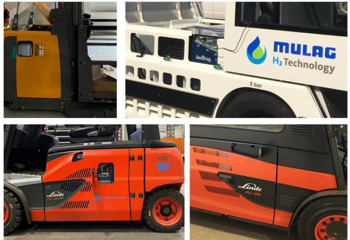
Abbildung 40: Positionierung der Betankungsschnittstellen am Fahrzeug
