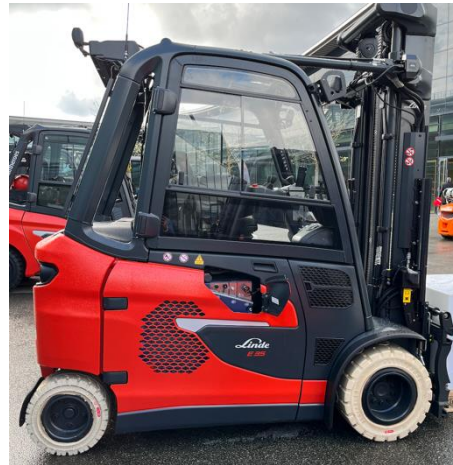
Abbildung 36: Linde-Stapler mit geöffneter Tankklappe für die H 2 -Betankung
