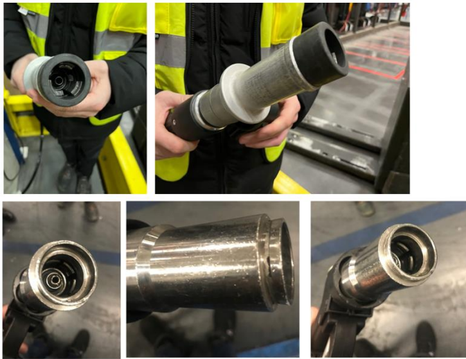
Abbildung 8: Abnutzungserscheinungen an der Füllkupplung
